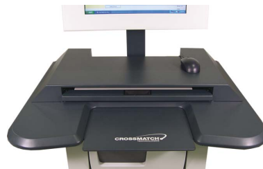
Einschiebbare Metallabdeckung schützt Aufnahmefläche des Scanners
